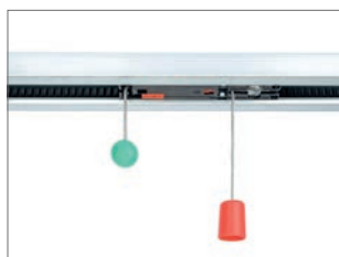
Déverrouillage d'urgence En cas de panne de courant, il est possible d'ouvrir et de refermer la porte en toute fiabilité via le déverrouillage d'urgence. Il suffit de tirer sur le déverrouillage pour déconnecter la porte de l'automatisme. La porte peut être commandée manuellement.
